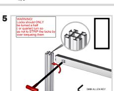
LOCK EXTRUSION BY USING 5MM ALLEN KEY
